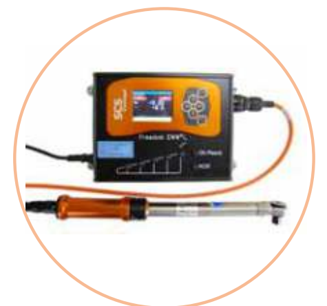
Alternatywne rozwiązania przewodowe przy użyciu EWW3 + FWELP TA brak rozpoznawania pozycji
